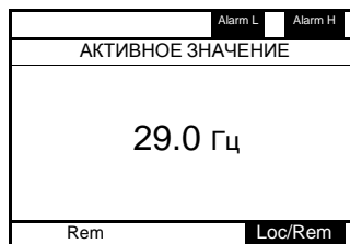
Сигнализации перегрузки двигателя и перегрева ПЧ
